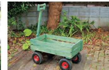
狭い路地でもラクラクの台車 神奈川県・山口 泰史さん SPFの1×4材の防腐・防蟻処理材に、水性のステイン風の塗料を使用。
